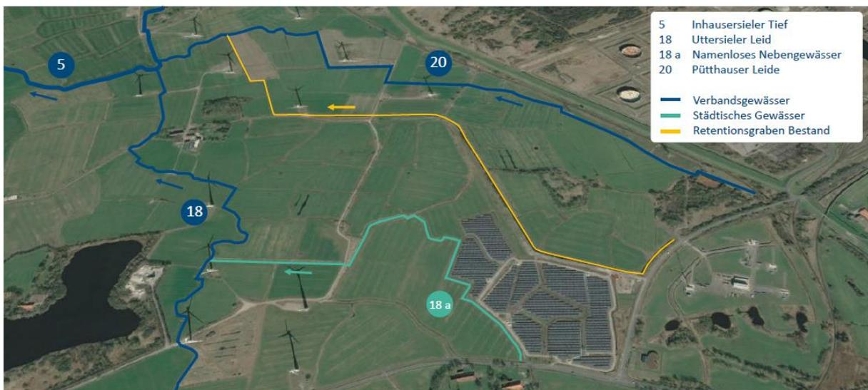
Abbildung 12: Entwässerung im Bestand<sup>7</sup>
